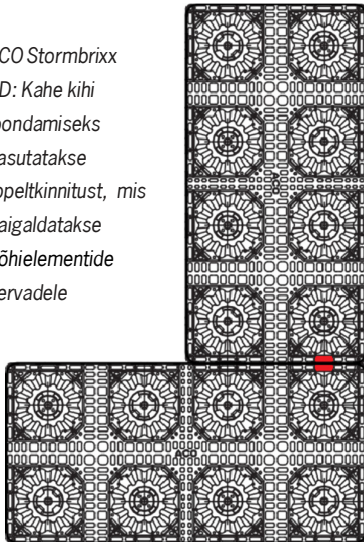
ACO Stormbrixx SD: Kaks kinnitust lukatakse omavahel kokku selleks, et fikseerida omavahel kaks paigalduskihti
